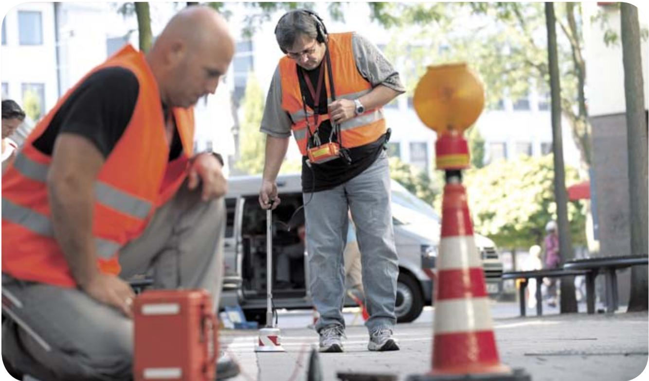
Verschwendung aufdecken und Sicherheit gewährleisten: Gasleckortung mit Bodenmikrofon.
