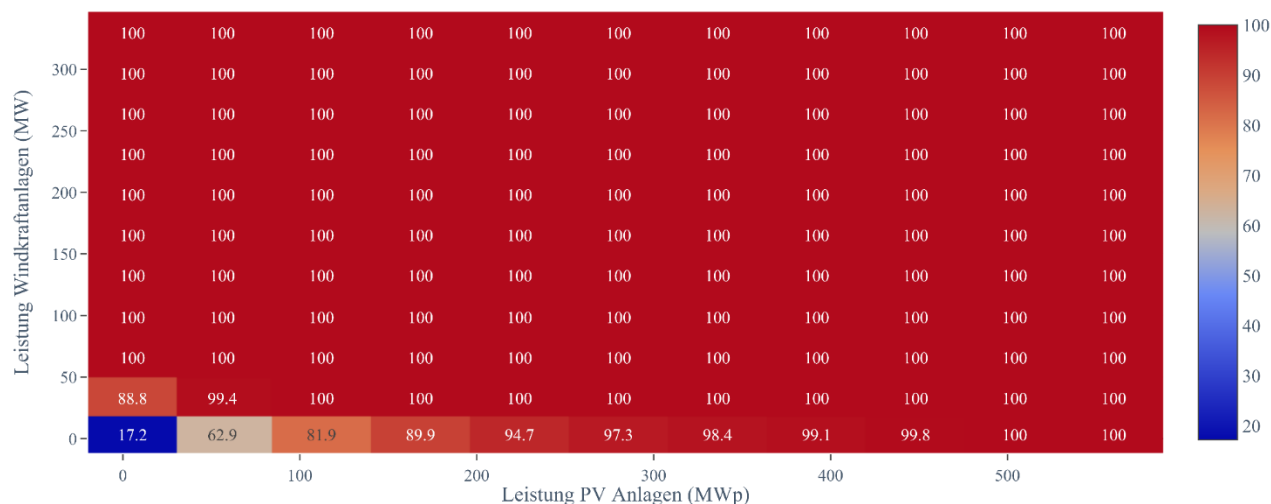
Abbildung 4: Abdeckungsrate über Maximalleistungen durch Windkraft- und PV Anlagen mit einem Speicher der Kapazität 5 MWh und 5 MW Leistung (e-netz Südhessen AG, 2025)
