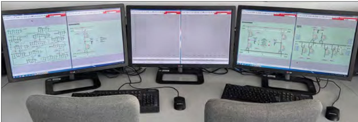
Abbildung 2. Ein Arbeitsplatz des Netztrainingssystems mit mehreren Monitoren und sechs HMI mit unterschiedlichen Darstellungen (etwa Topologie, Messkurven)
