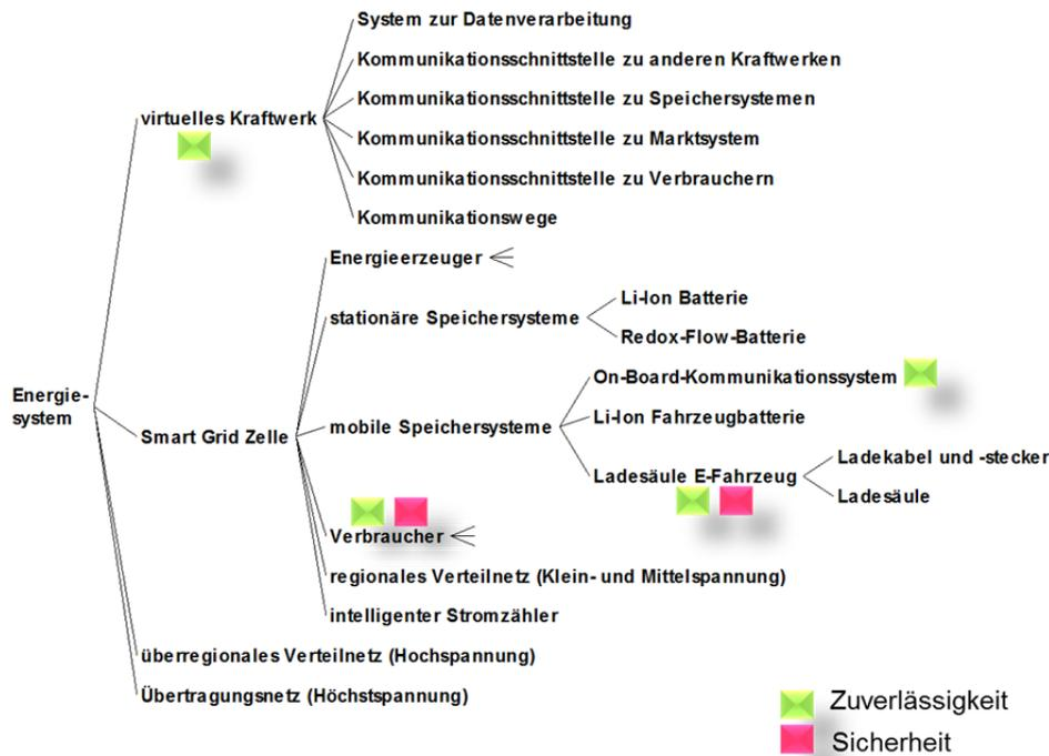
Abbildung 7. Auswahl der Subsysteme für die Zuverlässigkeits- (grün) und Sicherheitsbetrachtung (rot).
